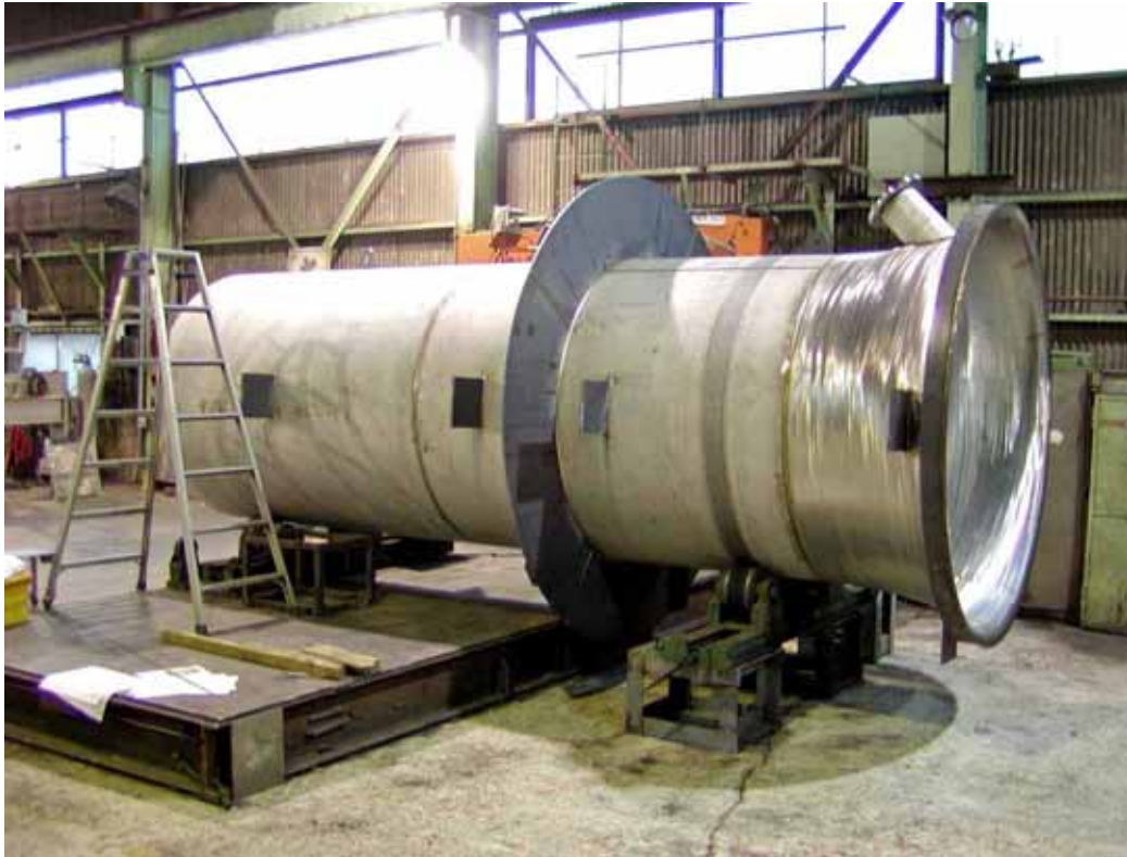
呑口管 ダム取水用放流管 1,000 SUS304 / SS400
